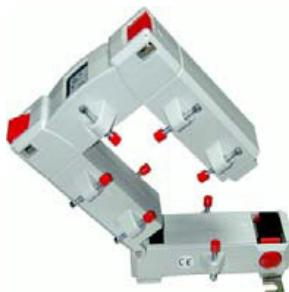
Gamma di Trasformatori Amperometrici da 100A fino 2500A con secondario /5A. Materiale magnetico a bassissima perdita. Sistema di sgancio brevettato a scatto e senza viti. Bloccaggio per barra di corrente. Sistema di fissaggio da quadro. Dimensioni ridotte.
