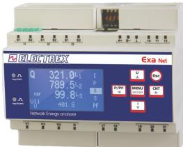
Energy Analyzer & Data Manager. Classe di precisione 0,5S e singole armoniche fino al 51° ordine. Con orologio/calendario astronomico perenne batterizzato e memoria non volatile. Aggiornamento firmware da remoto. Porta RJ45 e RS485 slave. Display grafico LCD. 2 ingressi e 2 uscite digitali. 1 led di calibrazione. ExpBus per dispositivi esterni (ingressi e uscite, sensori ambientali). Predisposto per NFC. Dimensione 6 moduli DIN. Alimentazione 85÷265Vac.
