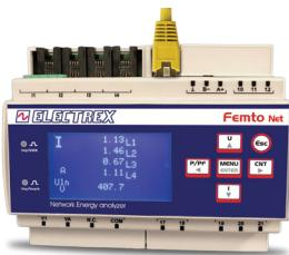
DC Energy Analyzer & Data Manager. Classe di precisione 0,5S. Con orologio/calendario astronomico perenne batterizzato e memoria non volatile. Aggiornamento firmware da remoto. Porta RJ45 e RS485 slave. Display grafico LCD. 1 led di calibrazione. ExpBus per dispositivi esterni (ingressi e uscite, sensori ambientali). Predisposto per NFC. Dimensione 6 moduli DIN. Alimentazione 85÷265Vac.
