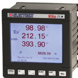
Energy Analyzer & Data Manager. Classe di precisione 0,5S e singole armoniche fino al 51° ordine. Con orologio/calendario astronomico perenne batterizzato e memoria non volatile. Aggiornamento firmware da remoto. Porta RJ45 e RS485 slave. Display grafico LCD. 2 ingressi e 2 uscite digitali. 1 led di calibrazione. ExpBus per dispositivi esterni (ingressi e uscite, sensori ambientali). Predisposto per NFC. Dimensione 96x96. Alimentazione 85÷265Vac.
