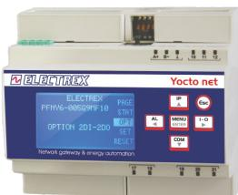
Gateway per la gestione remota di strumenti e reti electrex. INPUT / OUTPUT digitali e/o analogici, comunicazione ethernet, RS485, WIRELESS, GSM, SMS. generazione automatica di allarmi. memorizzazione e acquisizione remota di dati. misure online di strumenti. Dimensione 6 moduli DIN. Alimentazione 85÷265Vac.
