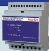
Trasduttore / analizzatore di energia senza display progettato per applicazioni bordo macchina in abbinamento a PLC e per il monitoraggio dell'energia a bassi livelli. Ha le stesse caratteristiche del Femto sopra riportate ed è disponibile in due versioni: 2 uscite analogiche 4-20mA oppure 1 ingresso e 2 uscite digitali. Dimensione guida DIN 4 moduli. Atto è ordinabile in altre configurazioni hardware con diverse tipologie di alimentazione, di ingressi e uscite.
