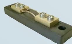
Gamma di Shunt (derivatori di corrente) in classe 0,5%. Caduta di tensione 60mV. Le versioni con portate da 10A e 25A sono dotate di base in plastica isolante di supporto. Tutti i modelli sono conformi alla normativa DIN 43073.
