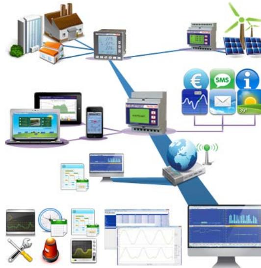
In quest'ottica nell'estate del 2013 la direzione ha deciso di installare nello stabilimento un [sistema di monitoraggio Electrex](#) composto da vari strumenti che rilevano i dati dei consumi generali di energia elettrica dello stabilimento, dei due trasformatori e quelli dei consumi generali di gas (tramite 2 analizzatori X3M H e 1 Yocto I-O connessi ad 1 network bridge Yocto net).
