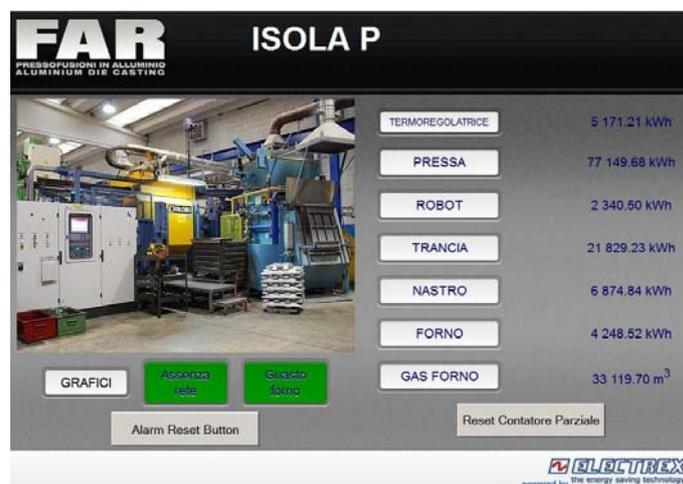
Tramite un pulsante posto sulla pagina web l'operatore, tramite smartphone, palmare o tablet. può effettuare il Reset dei contatori in modo da ottenere al termine delle lavorazioni i totali dell'energia elettrica e del gas utilizzati per ogni ciclo di lavoro.
