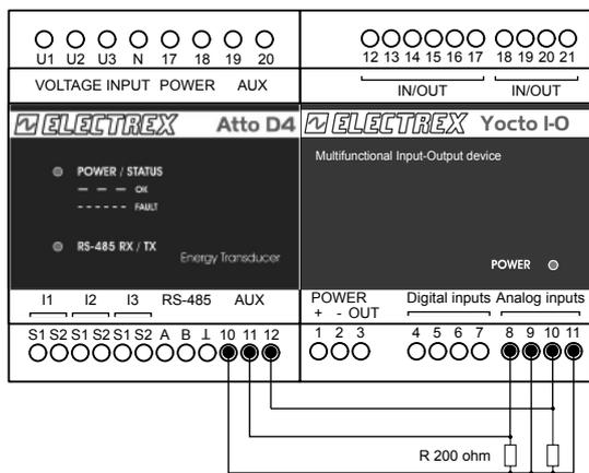
In questo caso la resistenza di carico applicata alle due uscite 4-20 mA del Femto risulta essere di 200 ohm. Tale valore corrisponde alla resistenza applicata sullo strumento Yocto IO per utilizzare i suoi ingressi analogici come ingressi 4-20 mA. Non richiede alimentazione esterna, in quanto, inferiore ai 250 ohm.
