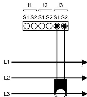
N.B. Rispettare scrupolosamente l'abbinamento di fase tra i segnali voltmetrici e amperometrici. Il mancato rispetto di tale corrispondenza e degli schemi di collegamento dà luogo ad errori di misura.
