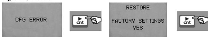
Una volta eseguita questa procedura lo strumento ripartirà con i parametri impostati in fabbrica. Il restore dello strumento non comporta la perdita dei valori registrati nel corso del suo funzionamento.
