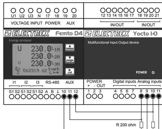
In questo caso la resistenza di carico applicata alle due uscite 4-20 mA del Femto risulta essere di 200 ohm. Tale valore corrisponde alla resistenza applicata sullo strumento Yocto IO per utilizzare i suoi ingressi analogici come ingressi 4-20 mA.
