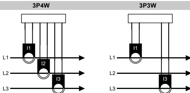
N.B. Rispettare scrupolosamente l'abbinamento di fase tra i segnali voltmetrici e amperometrici. Il mancato rispetto di tale corrispondenza e degli schemi di collegamento dà luogo ad errori di misura.
