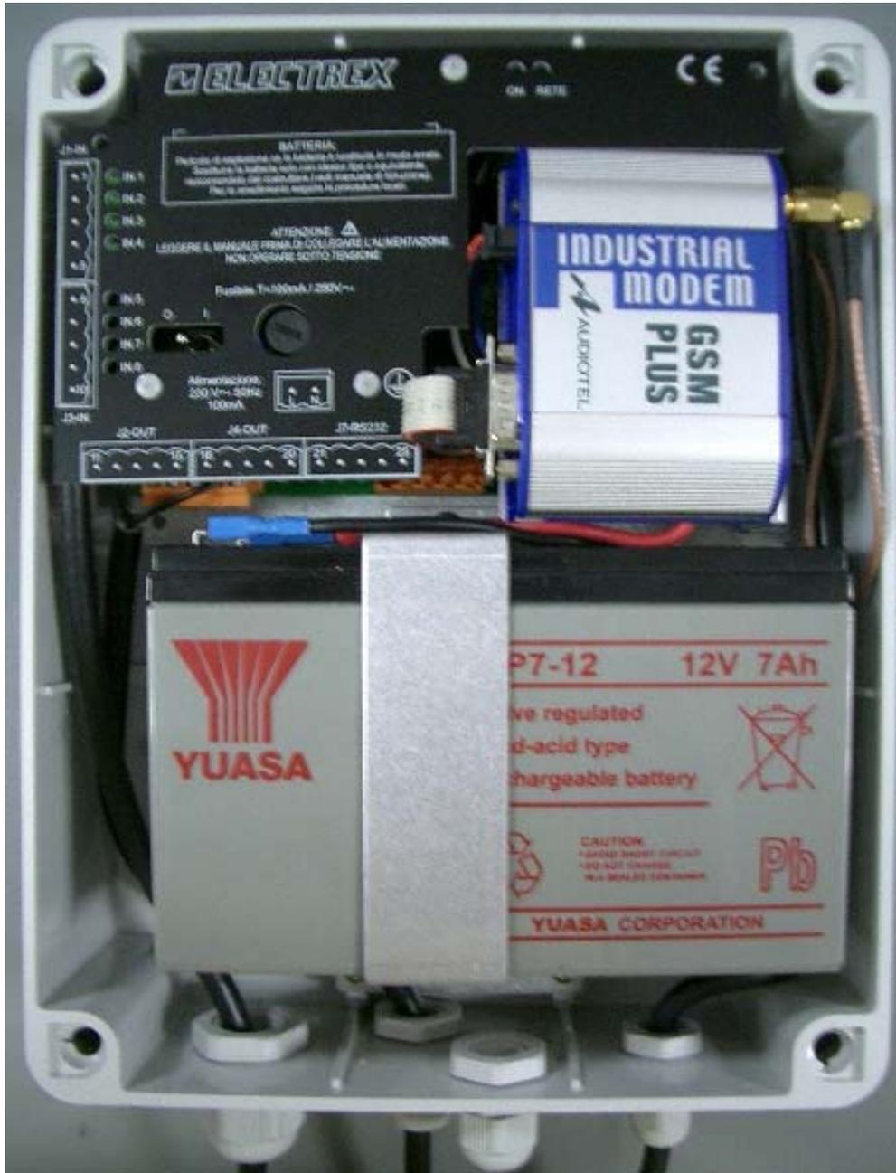
Tutte le connessioni sono accessibili smontando il pannello presente sopra all'elettronica (vedi figura), che deve essere rimontato dopo aver concluso le fasi di installazione.
