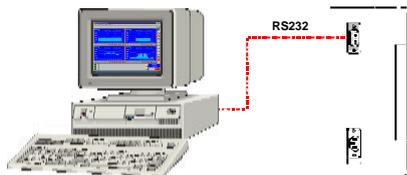
Utilizzando la porta seriale posizionata sulla parte laterale dello strumento è possibile collegare il KILO-BOX ad un PC, e attraverso i software KILO-GRAPH e KEvent, verificare e memorizzare le curve di consumo.
