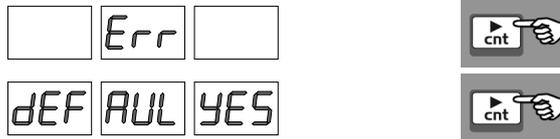
Una volta eseguita questa procedura lo strumento ripartirà con i parametri impostati in fabbrica. Il restore dello strumento non comporta la perdita dei valori registrati nel corso del suo funzionamento.
