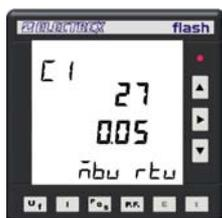
Attraverso questa schermata è possibile impostare diversi parametri. Lo Slave Address è il primo valore lampeggiante che compare. Il ritardo di trasmissione è il secondo parametro ed è espresso in secondi (nella figura quindi è 50 ms). Il terzo parametro è il tipo di protocollo di comunicazione MODBUS che può essere scelto fra RTU o ASC (ASCII).
