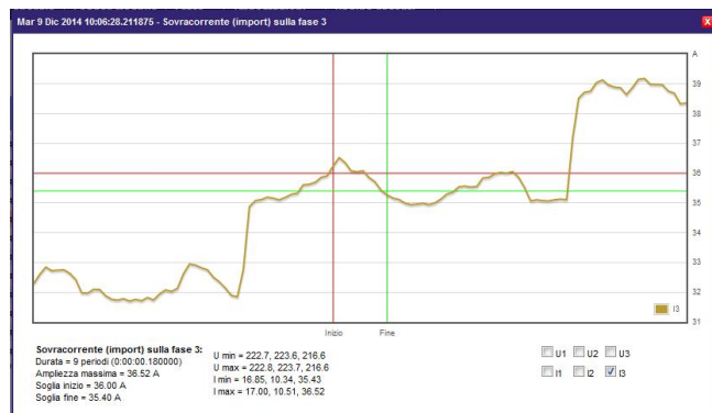
Esempio di sovracorrente sulla fase 3.
