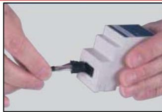
I moduli sono autoalimentati. Quando il modulo di interfaccia viene connesso allo strumento, l'applicazione relativa si avvia automaticamente.
