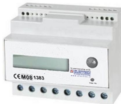
**Peta** è un contatore di energia elettrica attiva (trifase e monofase) con certificazione MID Moduli B + D. Disponibile in quattro versioni: connessione tramite trasformatori amperometrici /5A o connessione diretta e gestione di tariffa singola o doppia.
