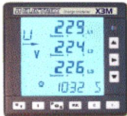
Un ampio display LCD ad alto contrasto con retro-illuminazione a led bianchi permette la lettura simultanea di 4 misure e del loro simbolo identificativo con caratteri ad alta visibilità. Un indicatore bargraph completa la visualizzazione di 3 delle misure a display anche in formato analogico.
