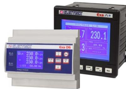
Gli Exa sono contatori/analizzatori di energia a microprocessore ideati per ambienti gravosi. Integrano la porta RS485 Modbus RTU. Indicazione del senso ciclico delle fasi, quattro conteggi di funzionamento oltre a più di cento misure. Versioni con ingressi e uscite digitali e analogiche. Svolgono le funzioni di analizzatore, contatore e multimetro.
