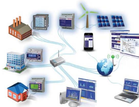
Consentono di controllare con un unico sistema la misurazione e la gestione di tutte le fonti energetiche (energia elettrica, gas, acqua, ecc.), dei parametri ambientali correlati ai consumi/produzione (temperatura, umidità, luminosità, ecc.) e di quelli di processo (aria compressa, livello, stato, ecc.).
