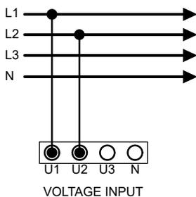
N.B. Rispettare scrupolosamente l'abbinamento di fase tra i segnali voltmetrici e amperometrici. Il mancato rispetto di tale corrispondenza e degli schemi di collegamento dà luogo ad errori di misura.
